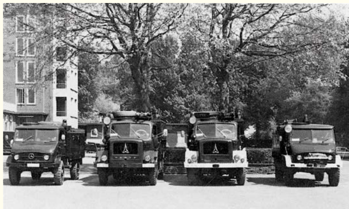
Fahrzeuge an der Hauptfeuerwache im Jahre 1982: v.l.: Tanklöschfahrzeug (TLF 8/8, Mercedes-Benz Unimog 404), zwei Löschgruppenfahrzeuge (LF 16-TS, Magirus-Deutz F Mercur 125 A) und ein Vorausrüstwagen (VRW, Mercedes-Benz Unimog 404).
